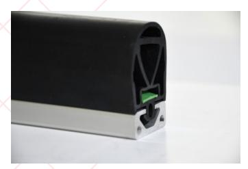
Die TS31 ist eine sehr vielseitige Schaltleiste für den Einsatz bei einer Fülle von Sicherheitsapplikationen. Durch Ihren speziellen Aufbau kann außerdem der unwirksame Randbereich aktiviert werden. Somit ist die Schaltleiste bis zum Rand aktiv. Der spezielle Profilfuß wurde entwickelt, um in Strebenprofile mit Nut 8 / 8i hineinzupassen. So kann die Schaltleiste auch in eventuell schon vorhandene Schienen mit dem entsprechenden Nut-Profil eingebaut werden.
