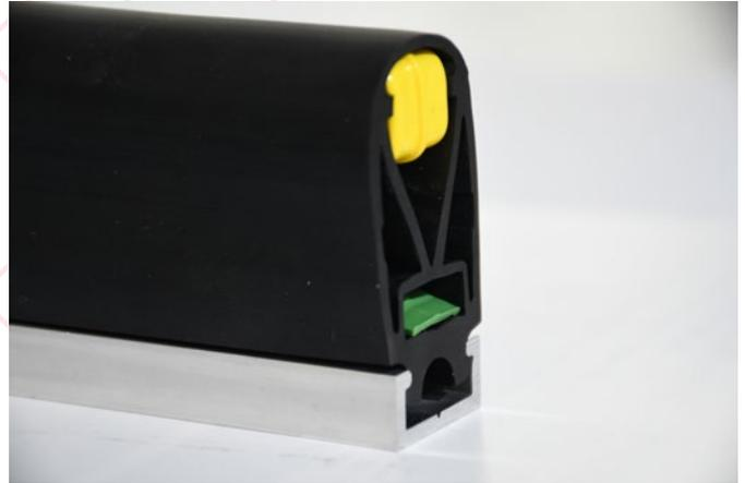
Die TS27 Schaltleiste bietet einen größeren Nachlaufweg als andere Modelle. Sie wird in der Standardversion mit zwei Bandschaltern bestückt, welche in der Fail-Safe-Version in Reihe geschaltet sind.
